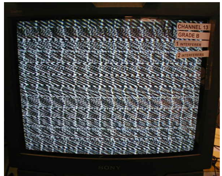
Помеха телевизионном сигнале
