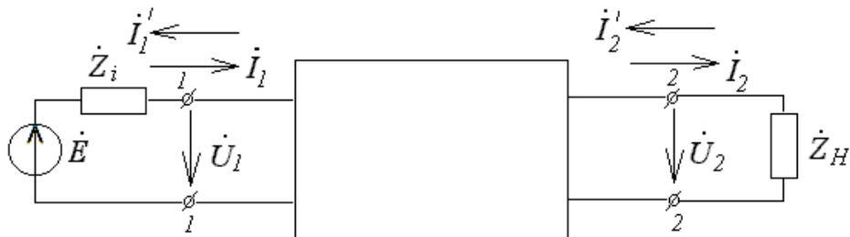
Четырехполюсниками являются фильтры, трансформаторы, усилители, каскады радиопередатчиков и радиоприемников, линии связи и т. д.
